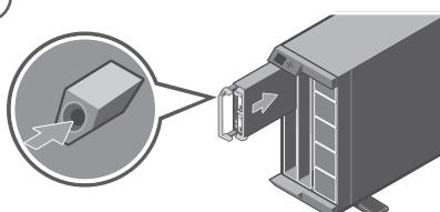
Começando a partir do topo, instale o(s) módulo(s) de servidor no gabinete, da esquerda para a direita. Empezando por la parte superior, instale los módulos del servidor en la carcasa de izquierda a derecha.
